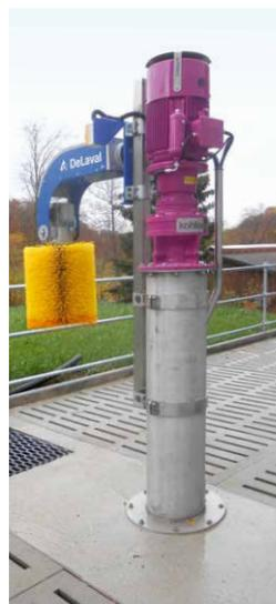
Le flotteur maintient toujours la pale d'agitateur à la bonne hauteur, directement sous la couche flottante. En cas de fosses profondes, une seconde pale d'agitateur, à montage fixe, est utilisée en plus. En cas de montage en hauteur de l'entraînement de l'agitateur, l'engrenage, le moteur et les raccords électriques sont protégés des animaux, de l'eau, de la neige et des sa-lissures.
